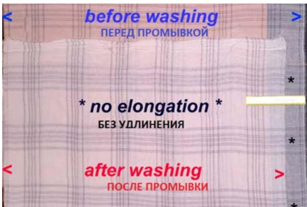
Рис. 8 – размеры ткани до и после промывки в Kinetika
