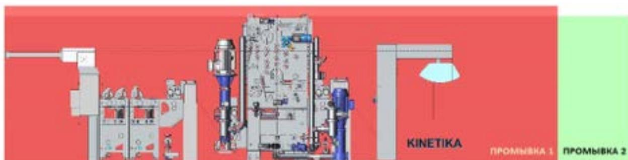
*Рис. 9 – сравнение размеров между Kinetika и двумя традиционными промывными машинами непрерывного действия*
